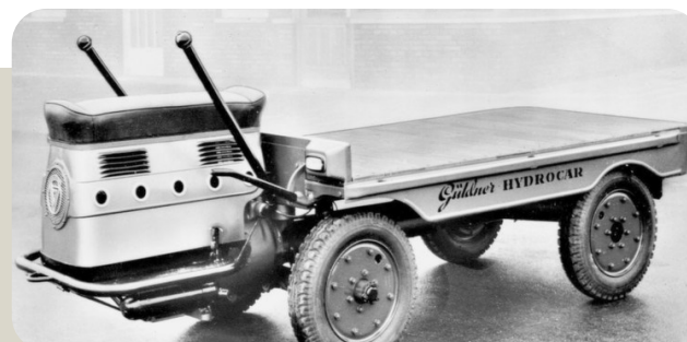
Hydrocar, první přepravní vozidlo s hydrostatickým pohonem (rok 1955)
