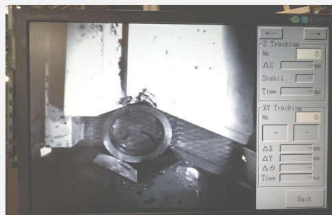
Pohled kamery na upnutý kroužek při procesu značení
