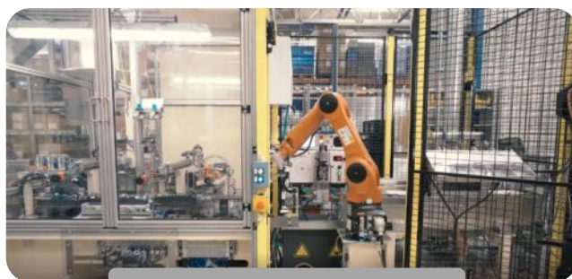
Montážní linka MC7 s robotem KUKA
